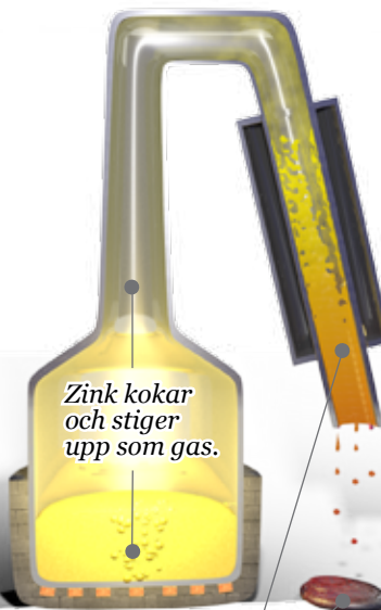
Zink kyls ner till flytande och därefter fast form.
